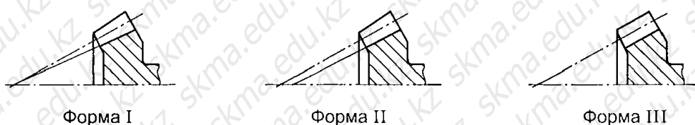
Рис. 6.3. Осовая форма зуба конического зубчатого колеса
